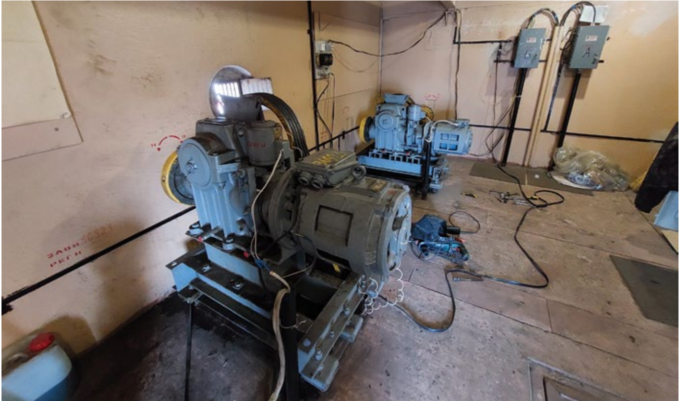
Электрические лебедки производства ОАО «Карачаровский механический завод», грузоподъемностью 400 и 630 кг
